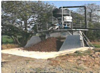
Sécheur à bandes du digestat solide
